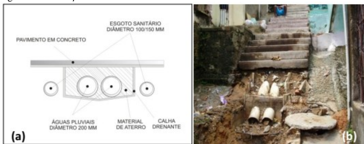
Figura 59 - Alterações nas escadarias drenantes.
