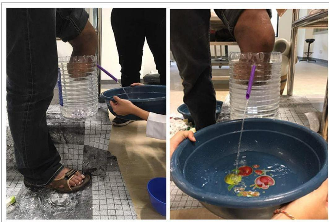
Figura 26 - Medição com método de deslocamento de água. Fonte: Mehmood et. al. (2019)
