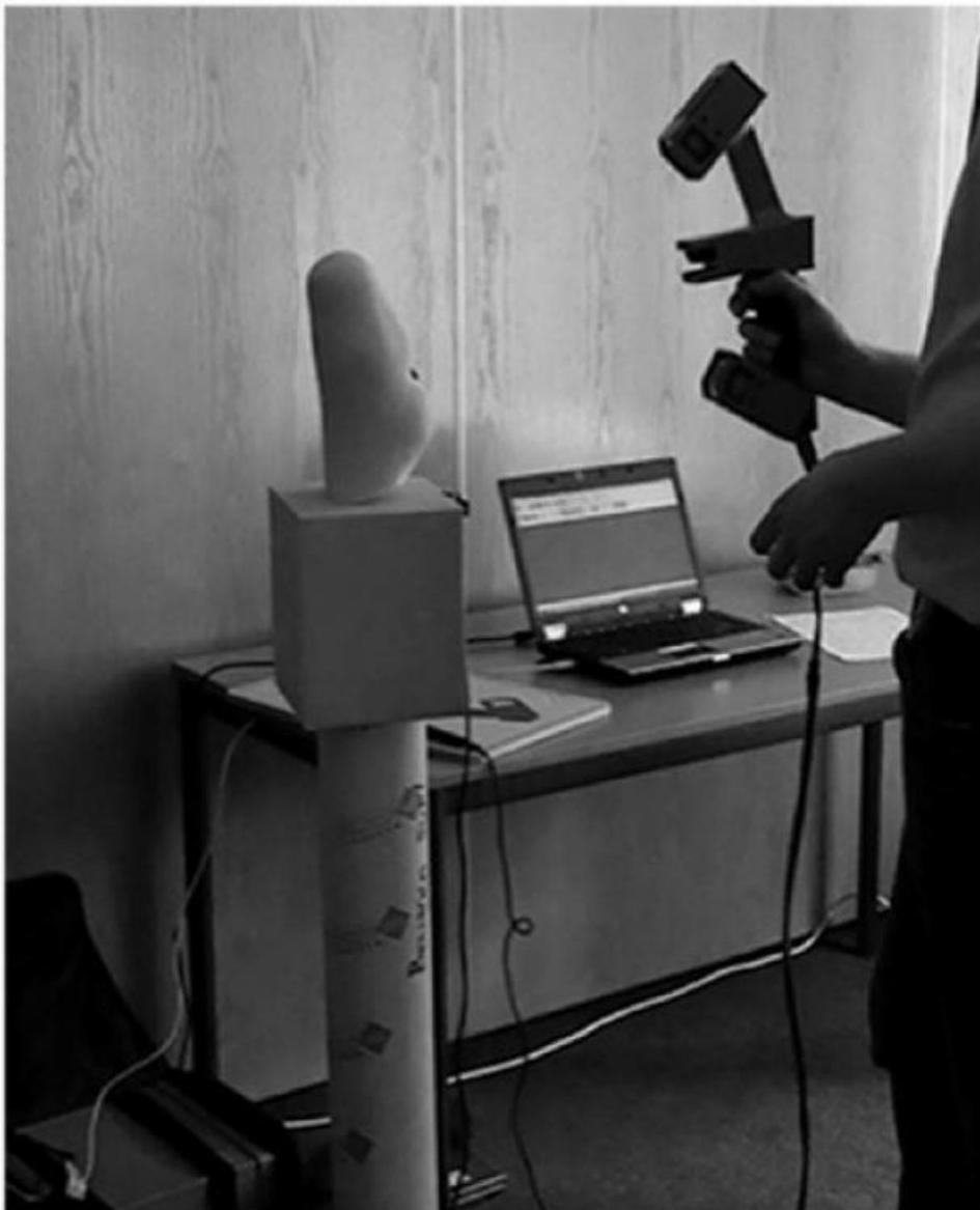
Figura 8 - Método de digitalização usando o Biosculpter. Fonte: Kofman et. al., 2018
