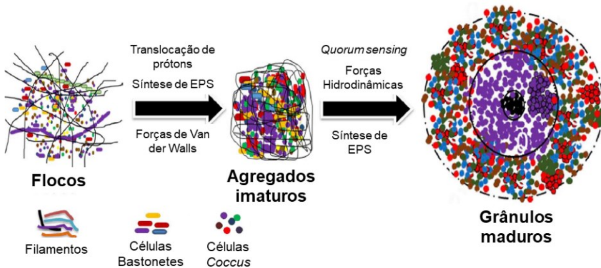
Figura 2: Representação esquemática do processo de formação de grânulos aeróbios e dos mecanismos envolvidos em cada etapa.
