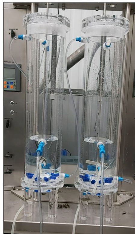
Figura 10: Dimensões esquemáticas (esquerda) e fotografia (direita) dos reatores em escala de bancada (SE-II).
