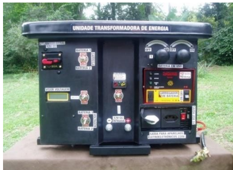
Parte móvel da Uges que acumula a energia gerada pelo consumo de água. (foto : Jorgea Correa)
