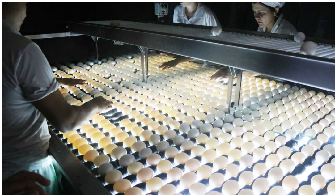
Figura 2 – Identificar ovos com imperfeições usando iluminação inferior.
