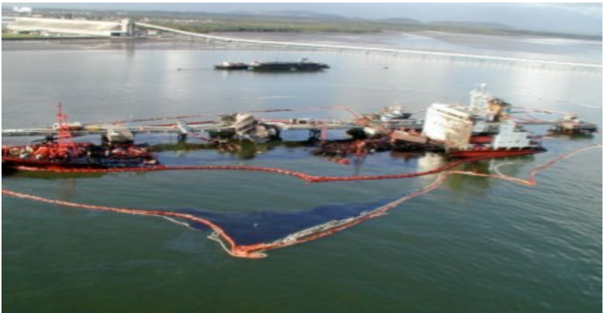
Figura 2: Contenção de óleo do navio
