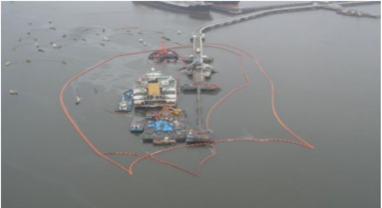
Figura 3: Sistema de contenção de óleo com barreiras
