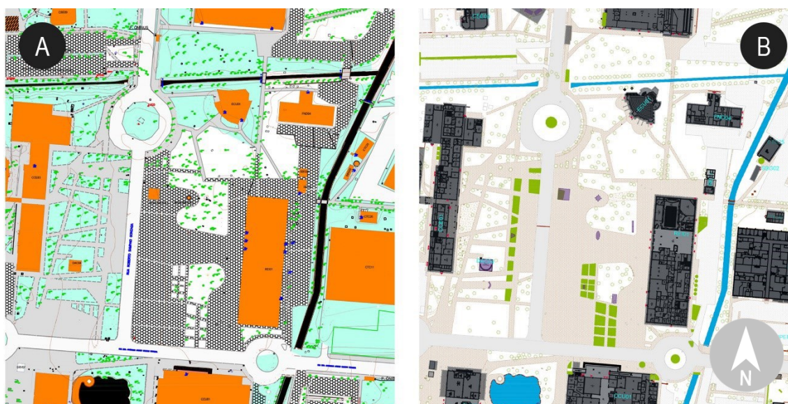
Figura 16 - Levantamento cadastral em 2012 (a) e atualizado em 2018 (b), incorporando a planta-baixa dos térreos edificadas e a delimitação das áreas de passeios pavimentados.
