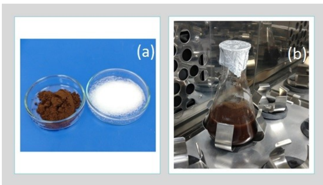
Figura 7 - (a) Lignina kraft (pó de cor marrom) e ácido cítrico (pó de cor branca). (b) Processo de impregnação de lignina nas membranas de NCB-CMC.
