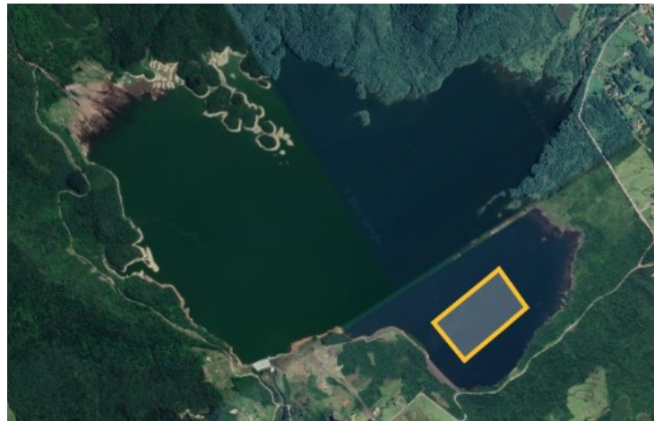
Figura 8 – Área provável para instalação de módulos fotovoltaicos no lago da barragem do rio São Bento.
