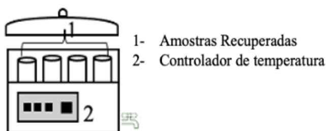
Figura 4 - Diagrama da unidade de extração por maceração (Banho).
