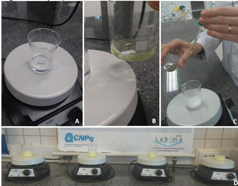
Fase aquosa; B- Fase orgânica; C- Gotejamento da fase orgânica sobre a fase aquosa; D-Evaporação do solvente sob agitação magnética.
