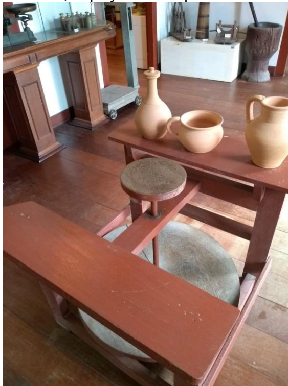
Figura 23 - O torno do oleiro, espaço onde o profissional molda a louça utilitária.
