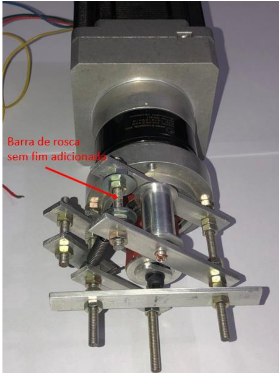
Figura 46 – Barra de rosca sem fim adicionada para otimização do sistema mecânico.
