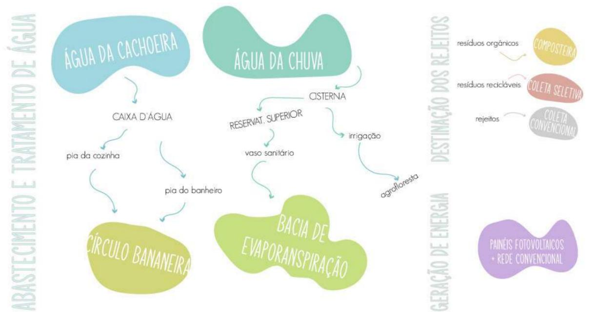
[73] Esquema dos sistemas de abastecimento de água e energia elétrica e destino e tratamento de resíduos.
