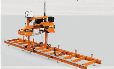
Equipamento de porte médio da empresa Woodmizer, possui um sistema de braço de guia que reduz e ajusta o curso da lâmina. Seu sistema de avanço é manual e se dá através de uma manivela que permite o equipamento cortar a madeira por toda sua extensão
