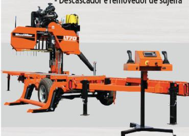
Equipamento mais completo do mercado atualmente, projetado para trabalhar em alta produção. O controle do equipamento se dá através de joystick e as informações são passadas ao operador através de uma tela. Sua operação é facilitada e exigem menos esforços físicos devido aos seus comandos hidráulicos que permitem a tora ser carregada, movimentada e rotacionada sem exigir esforço do operador.
