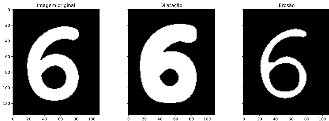
Figura 4 – Exemplo de dilatação e erosão
