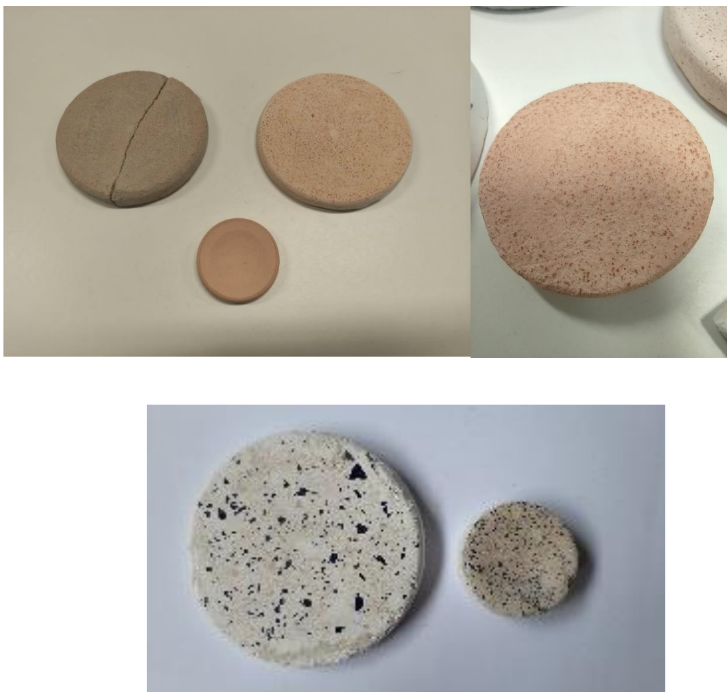
Figura 4 – Fotografias das amostras cimentícias com resíduos de caco cerâmico moído - em cima, fotografia do lado esquerdo: canto superior esquerdo – cimento cinza + caco fino chacoado (amostra fraturada), canto superior direito – cimento branco + caco grosso chacoado; em baixo – cimento branco + caco fino chacoado (amostra mais pequena); fotografia do lado direito: ampliação da amostra cimento branco + caco grosso chacoado ; em baixo, amostras de cimento branco + caco vidrado mais grosso (lado esquerdo) e cimento branco + caco vidrado mais fino (lado direito).
