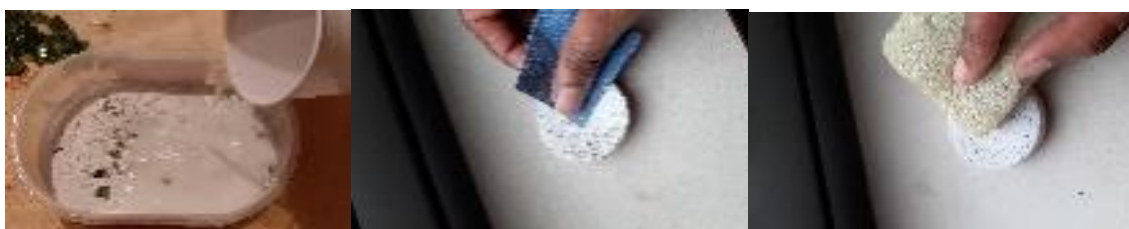
Figura 2 - Várias fases do processo de fabricação de amostras cimentícias com resíduos moídos de cerâmica e vidro: moldagem, lixamento e esponjamento.
