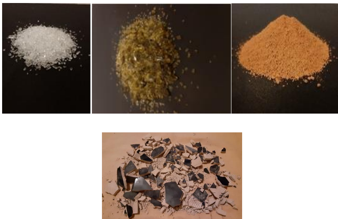
Figura 1 - Resíduos de vidro com diferentes graus de moagem - Casco de vidro transparente, casco vidro de cor, caco chacotado e caco vidrado cozido.
