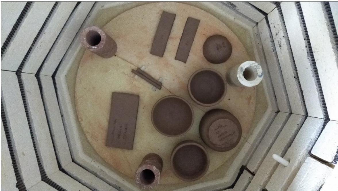
Figura 8 – 1ª cozedura (chacota) das experiências que serviram para testar a pasta.
