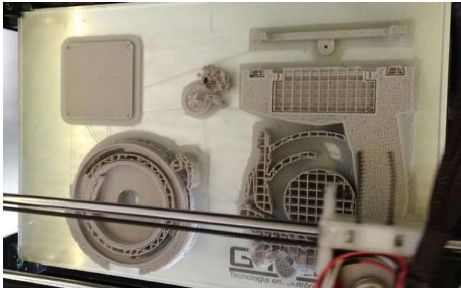
Figura 4: Colmeia em processo de impressão 3D. Fonte: fotografado pelos autores.
