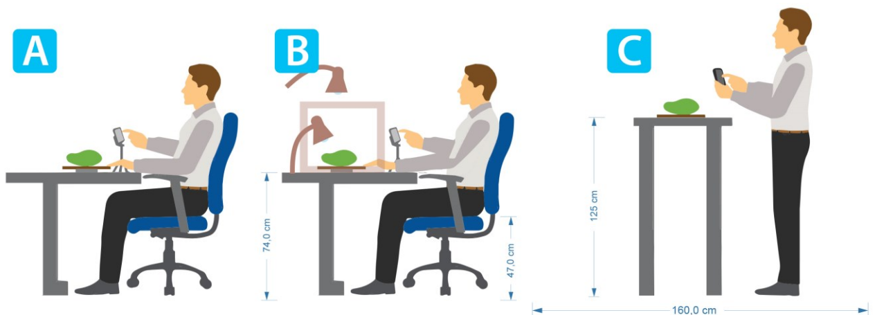
Figura 31 - Vista esquemática das dimensões dos cenários de coleta
