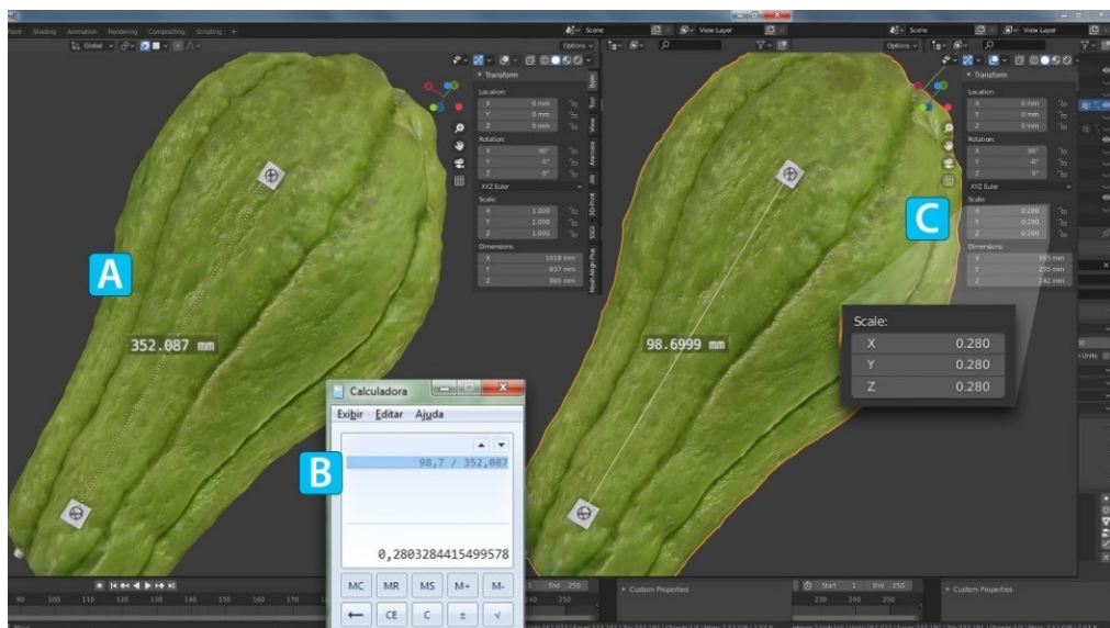
Figura 20 – Ajuste do fator de escala no Blender
