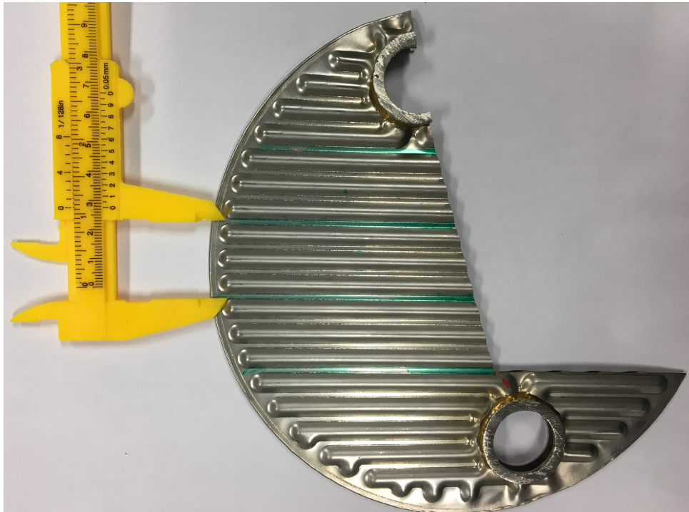
Figura 9 – Estrutura de placa corrugada e soldada a laser antes do tratamento térmico.
