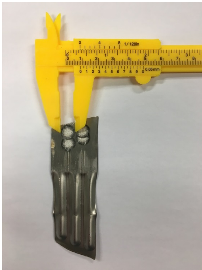
Figura 7 – CP-c1, Amostra Após Ensaio de Espectroscopia de Emissão Óptica.
