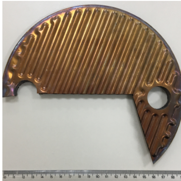
Figura 27 – Estrutura de placas corrugadas e soldadas a laser após tratamento térmico.
