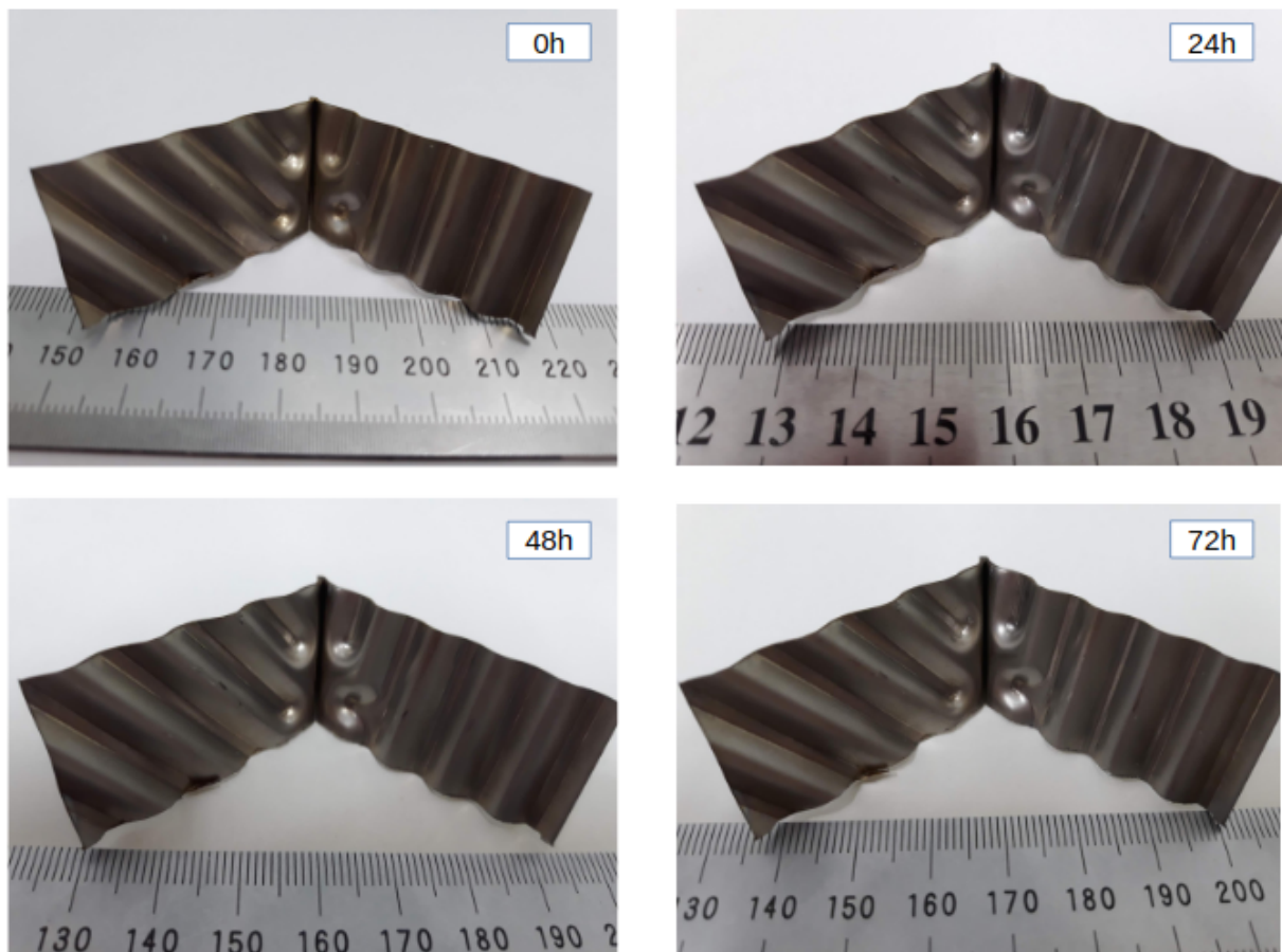
Figura 20 – Comparativo região de placa do CP-c4 para diferentes tempos de exposição ao ensaio de névoa salina - foco na região da placa corrugada.
