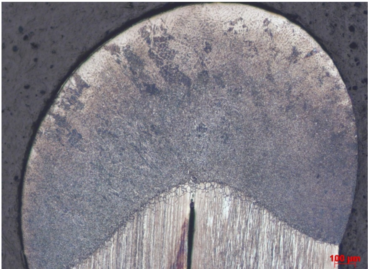
Figura 22 – Corte transversal do cordão de solda do PSHE, magnitude 100 \mu\text{m} .
