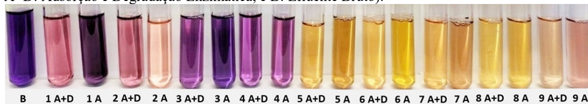
Figura 20 - Comparação visual da remoção de cor resultante do planejamento fatorial (A: Adsorção, A+D: Adsorção e Degradação Enzimática, e B: Efluente Bruto).
