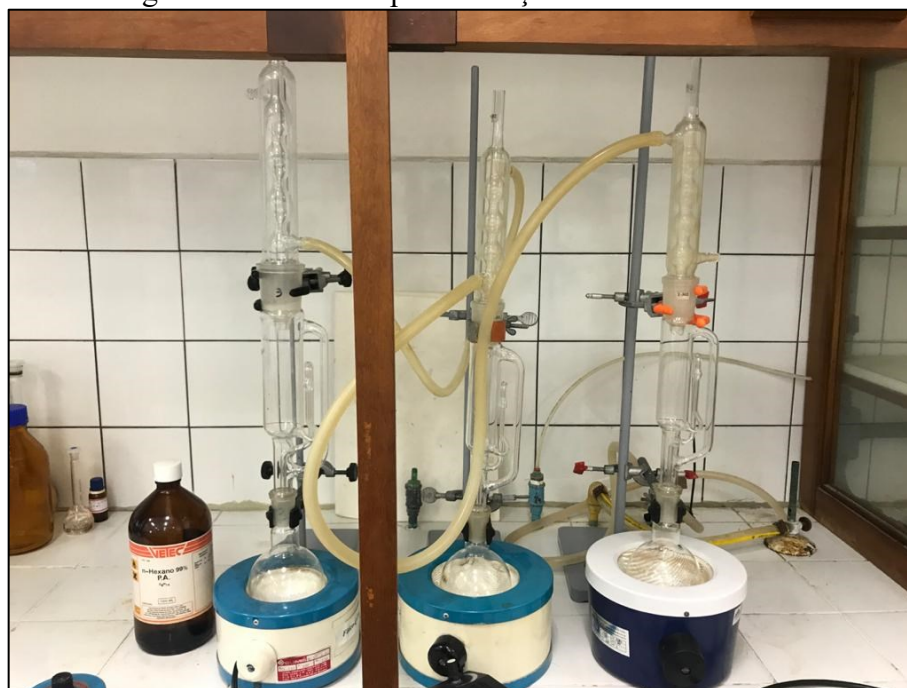
Figura F.1 – Sistema para extração utilizando Soxhlet.
