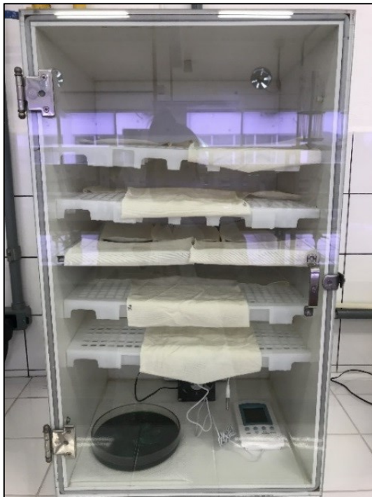
Figura G.1 – Estufa com atmosfera controlada com solução de cloreto de cobre saturada para condicionamento e ensaio de material têxtil.
