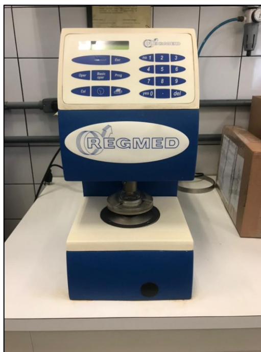
Figura G.7 – Equipamento Mullen Tester (REGMED MTA 2000) para ensaios de resistência ao arrebentamento/estouro.
