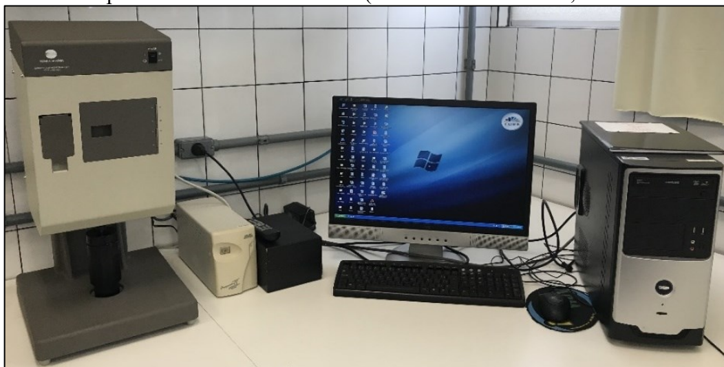
Figura G.4 – Espectrofotômetro de remissão (marca Konica Minolta, modelo CM-3610D).
