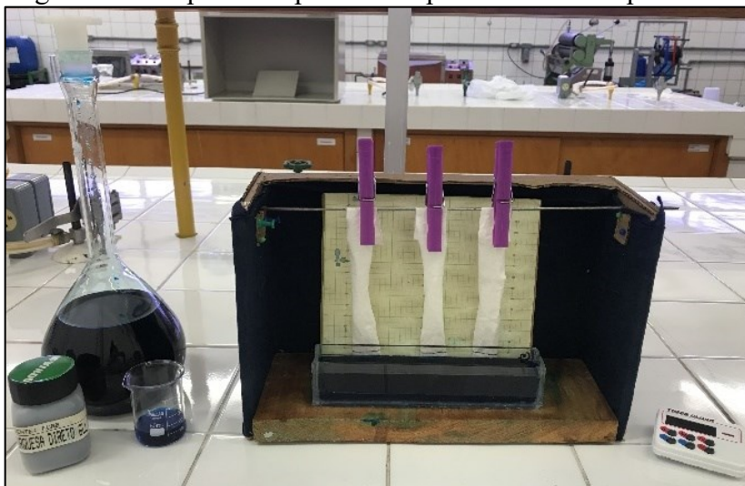
Figura G.3 – Aparato experimental para o teste de capilaridade.
