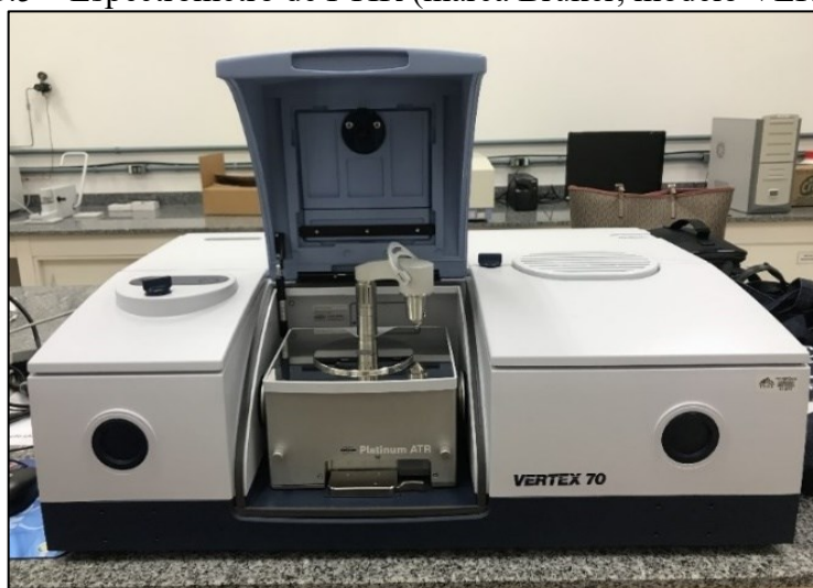
Figura G.5 – Espectrômetro de FTIR (marca Bruker, modelo VERTEX 70).
