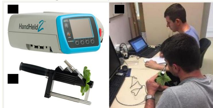
Figura 5A: Espectrorradiômetro ASD FieldSpec HandHeld 2. Figura 5B: Grampo de folha ASD. Figura 5C: Obtenção dos dados radiométricos de uma folha de videira. Fonte: Elaborada pelo autor (2021).
