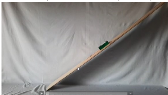
Figura 43. Aceleração do bloco sobre a ação da força de atrito.
