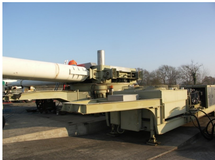
Figura 2.13 - Torre central e respectivo módulo eletromecânico de acionamento.
