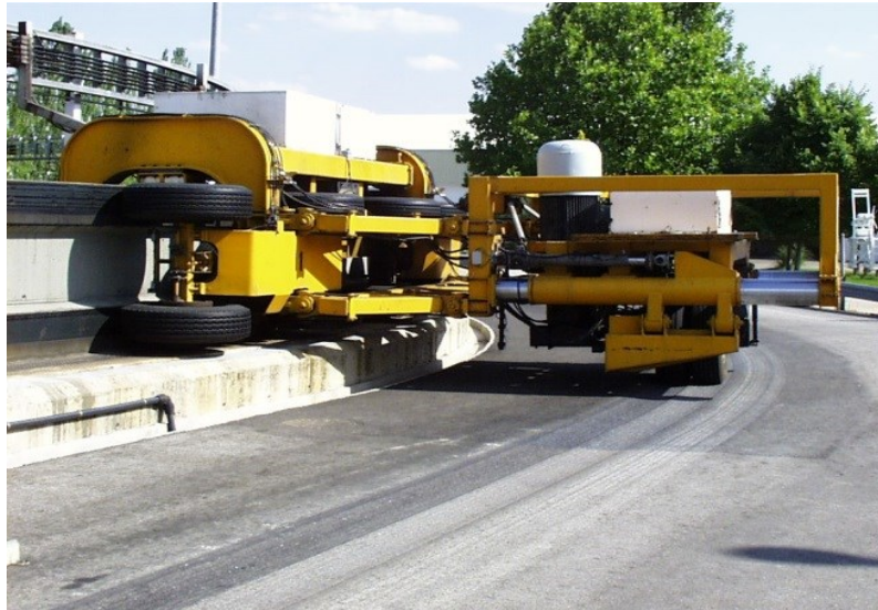
Figura 2.18 - Módulo automatizado de acoplamento dos eixos solicitantes.
