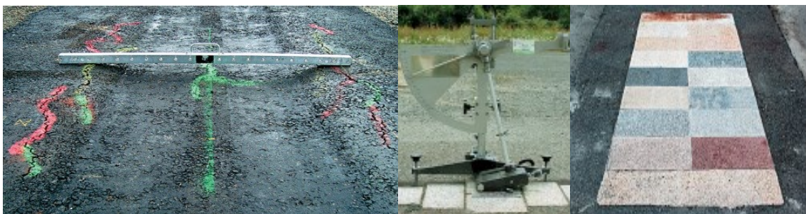
Figura 2.29 - Avaliação de afundamentos nas trilhas de roda, aderência pneu pavimento e desgaste superficial de revestimentos urbanos com a utilização do equipamento FABAC.
