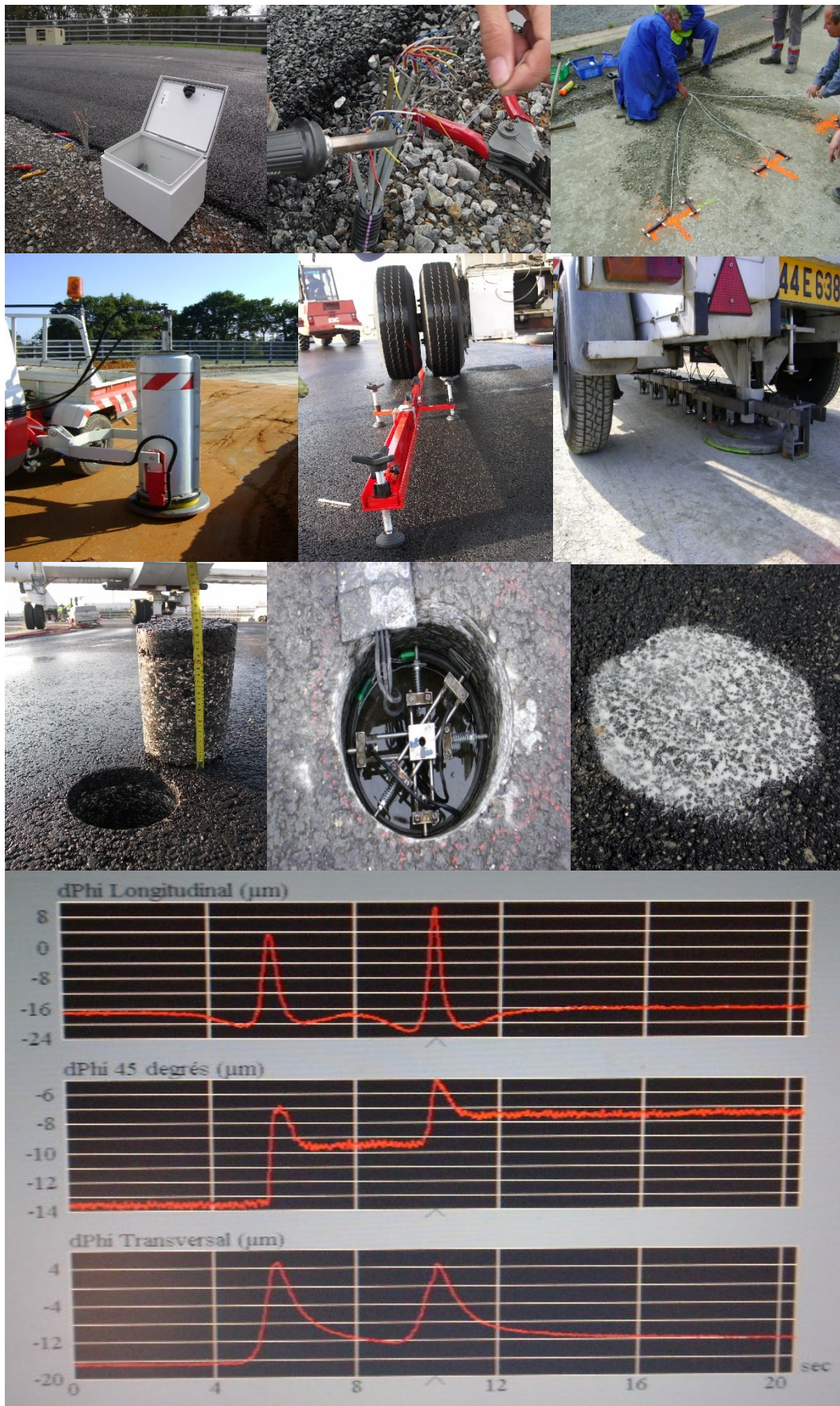
Figura 2.16 - Procedimentos de instrumentação, auscultação e monitoramento.
