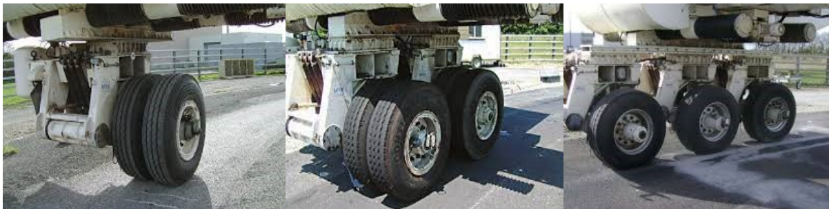
Figura 2.11 - Eixo (a) simples de roda dupla (ESRD), (b) tandem duplo (ETD) e (c) tandem triplo (ETT).
