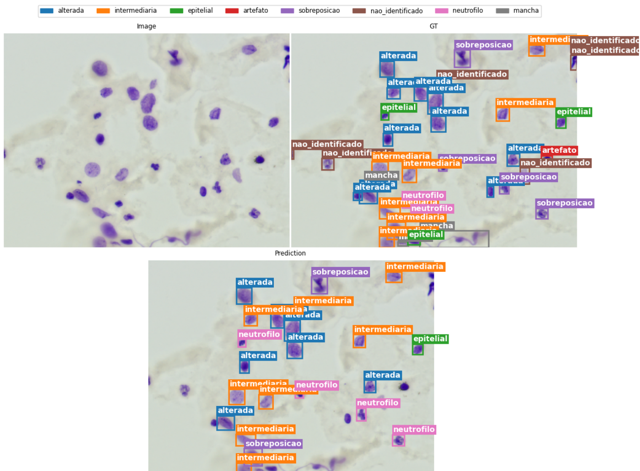
Figura 20 – Resultado das detecções para a RetinaNet + ResNet101. Linha superior - esquerda: imagem de entrada; Linha superior - direita: ground-truth ; Linha inferior: predição da rede neural.
