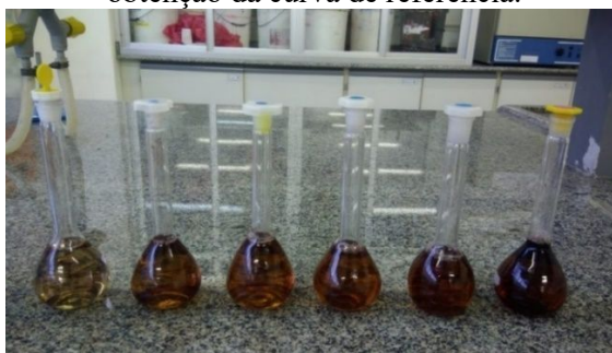
Figura 23- Soluções de ácido tânico com diferentes concentrações de 25 a 150 mg.L -1 , empregadas na obtenção da curva de referência.
