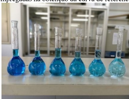
Figura 32- Soluções de azul de metileno com diferentes concentrações de 5 a 40 mg.L -1 do corante, empregadas na obtenção da curva de referência.
