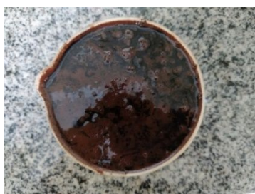
Figura 29 - Impregnação de KOH nas amostras carbonizadas.
