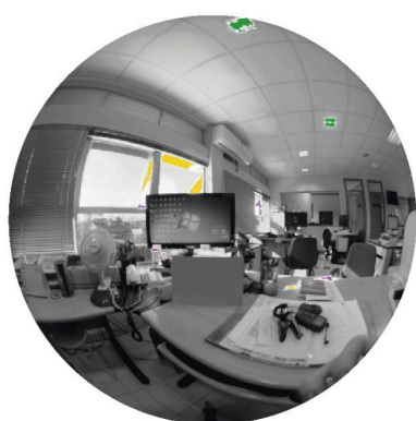
Figura 13 - Origens e índices de ofuscamento da posição 1 do observador 1. Fonte: elaborado pelos autores.
