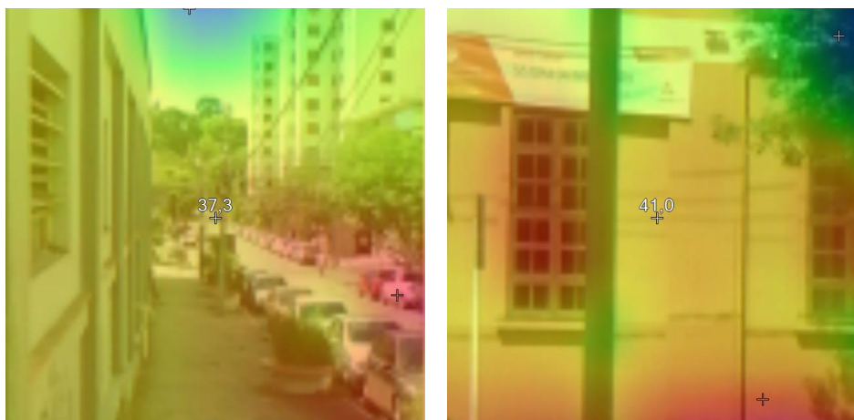
Figura 6: Medição em infravermelho do ponto 4. (a) lado direito e (b) lado esquerdo. Fonte: Smart View, adaptado pelos autores
