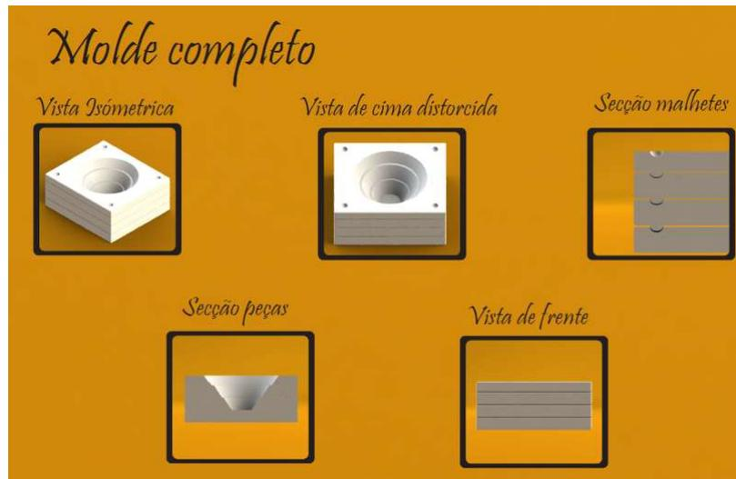
Figura 9 – Vistas da montagem do molde completo. Fonte: própria.
