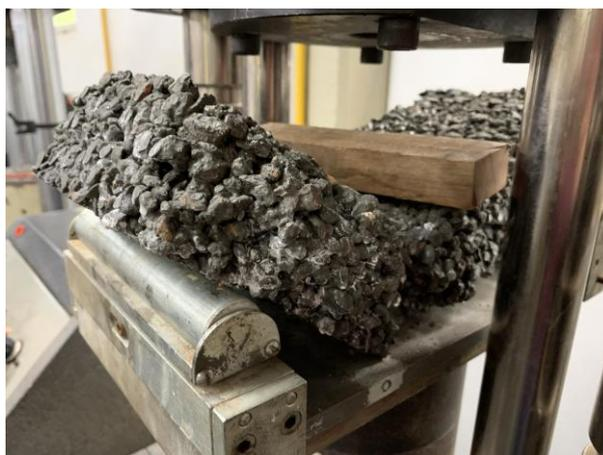
**Figura 2: Ensaio de tração na flexão. Fonte: elaborado pelos autores.**
