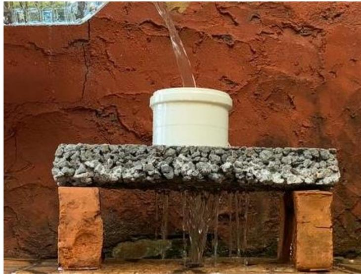
Figura 2: Ensaio para obtenção da taxa de infiltração. Fonte: elaborado pelos autores.
