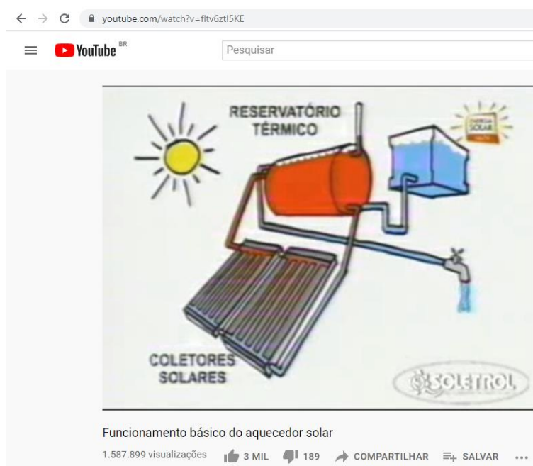
Figura 26 – Funcionamento do aquecedor solar
