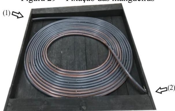
Figura 29 – Fixação das mangueiras
