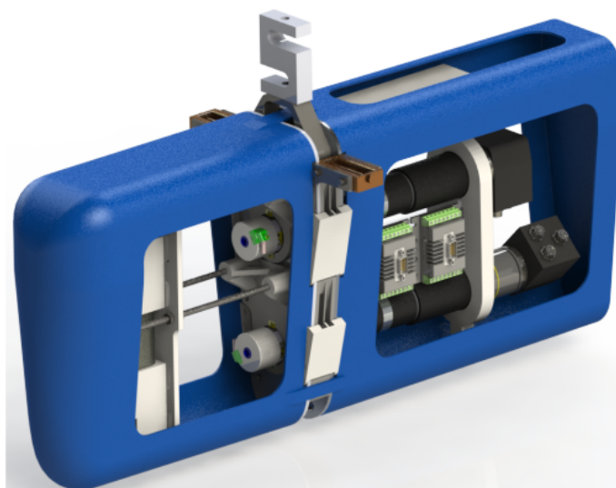
Figura 7 – Projeto em CAD da unidade de voo do AWE.
