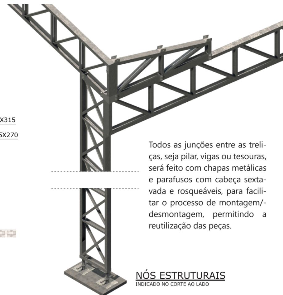
Todos as junções entre as treliças, seja pilar, vigas ou tesouras, será feito com chapas metálicas e parafusos com cabeça sextavada e rosqueáveis, para facilitar o processo de montagem/desmontagem, permitindo a reutilização das peças.
