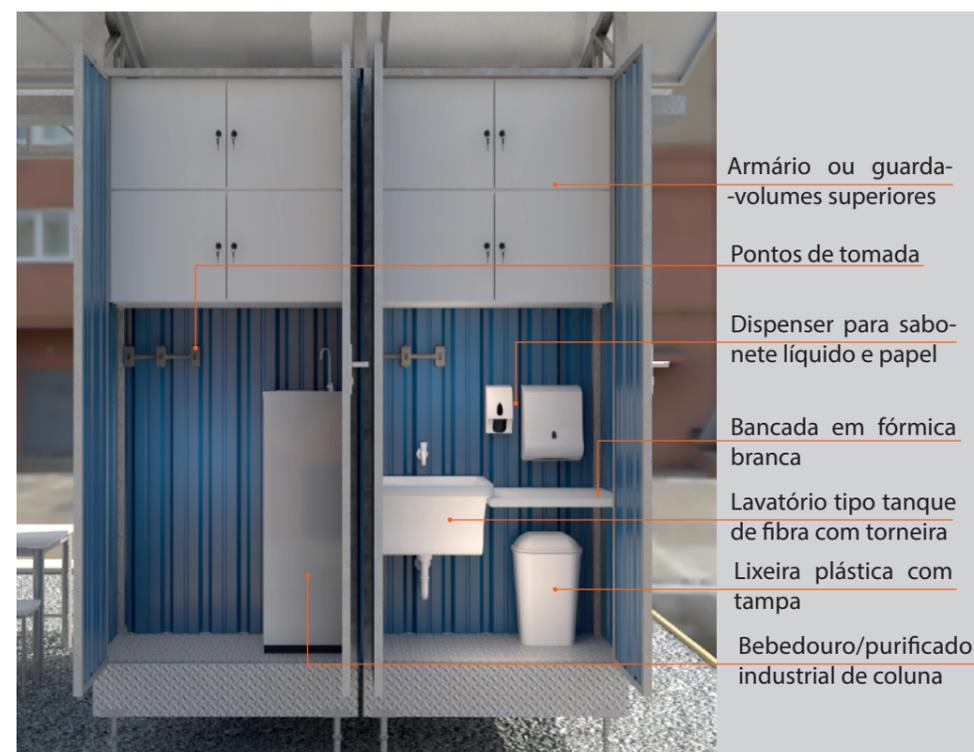
Figura 50 - Compartimento com bebedouro e lavatório. Fonte: acervo pessoal
