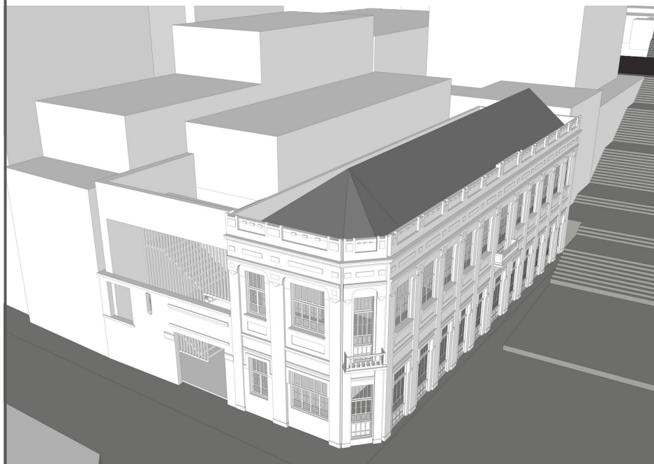
COBERTURA EM TELHA CERÂMICA
