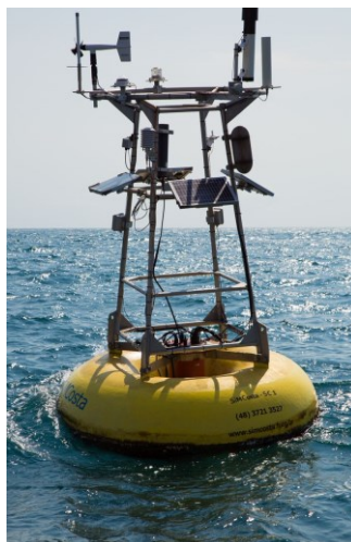
Figura 3: Boia meteo-oceanográfica do Sistema de Monitoramento Costeiro do Brasil (SIMCosta) SC-01, fundeada no litoral de Santa Catarina, dentro da Reserva Biológica Marinha do Arvoredo.
