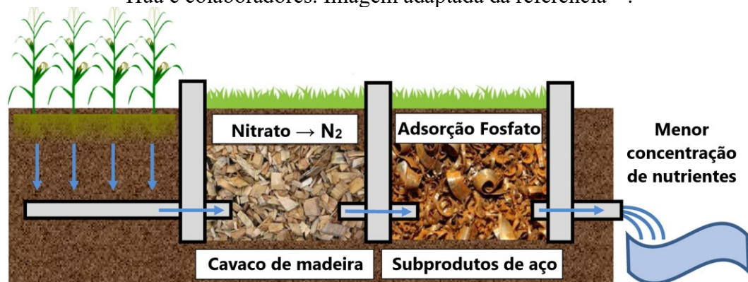
Figura 10. Representação do sistema de tratamento de drenagem subterrânea elaborado por Hua e colaboradores. Imagem adaptada da referência 48 .
