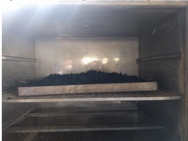
Figura 10 - Lodo em processo de secagem em estufa.
