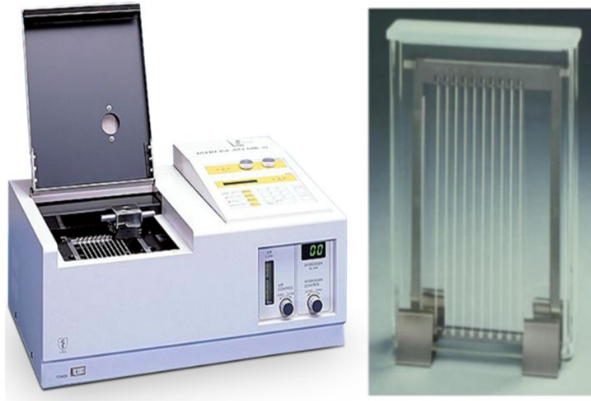
Figura 2.3 - Cromatógrafo IATROSCAN e respectivas colunas capilares.
