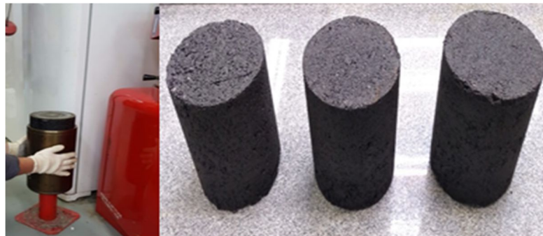
Figura 5.13 - Processo de extração dos corpos de prova resultantes do processo de compactação pela PCG.
