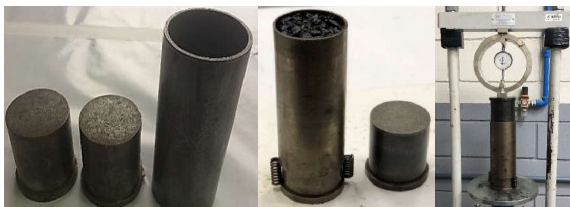
Figura 5.15 - Processo de compactação das amostras por duplo pistão.
