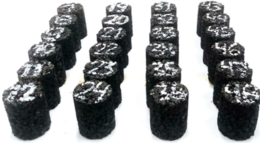
Figura 5.16 - Corpos de prova após o processo de extração.
