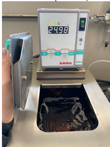
Figura 5.7 - Visão geral do banho termostático para circulação do fluido indutor de temperatura.
