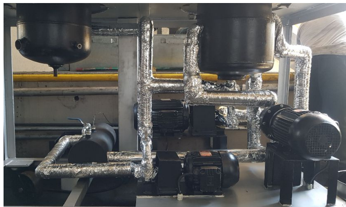
Figura 5.2 - Moinho piloto utilizado na modificação do ligante betuminoso.
