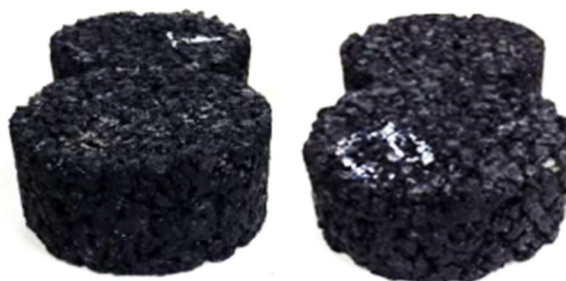
Figura 5.30 - Corpos de prova utilizados nos ensaios Hamburgo.
