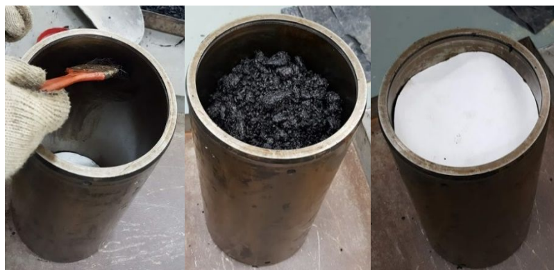
Figura 5.12 - Preparação das amostras antes da execução do ensaio.
