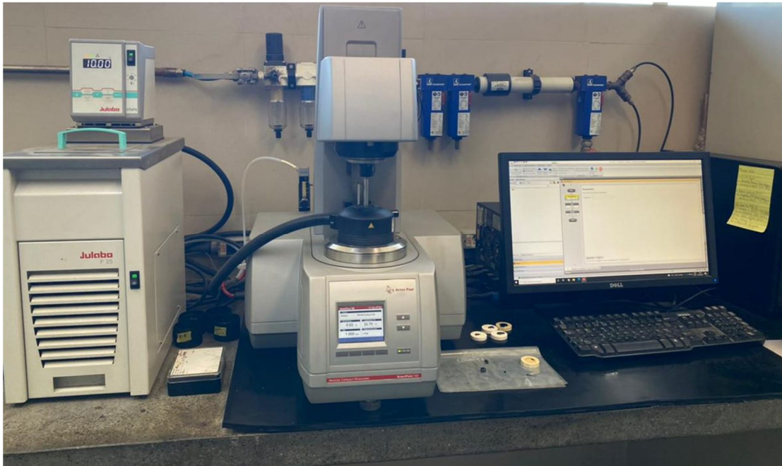
Figura 5.5 - Reômetro de cisalhamento dinâmico SMARTPAVE 102 - Anton Paar.
