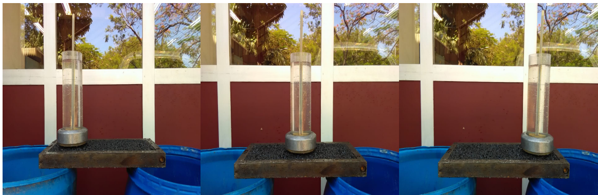
Figura 5.25 - Permeâmetro posicionado no bordo esquerdo, eixo e bordo direito da placa.
