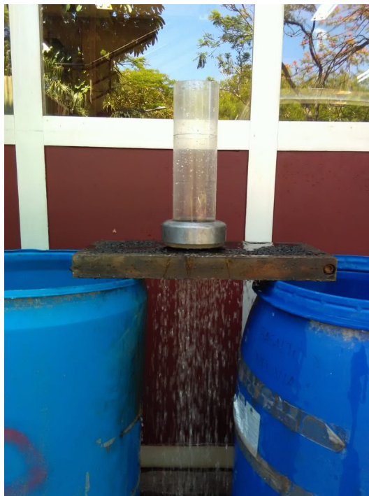
Figura 5.26 - Determinação da permeabilidade vertical das misturas asfálticas BBDr.
