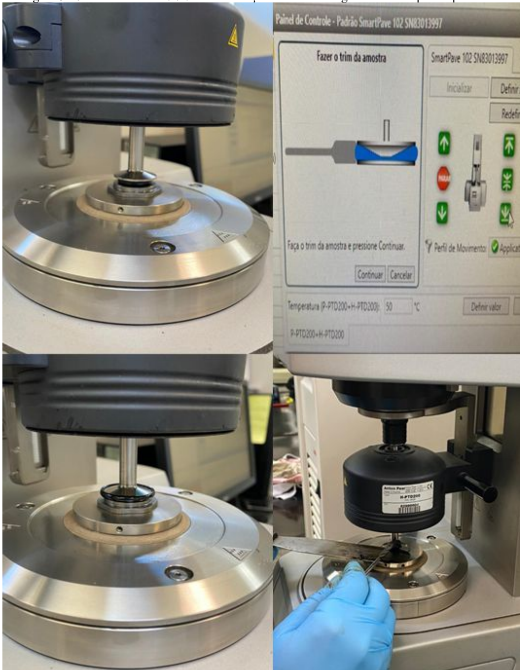
Figura 5.10 - Procedimento trim e conformação da amostra à geometria das placas paralelas.
