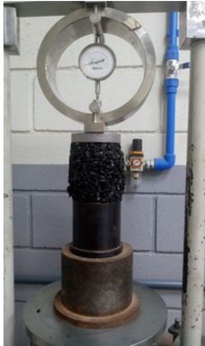
Figura 5.20 - Ruptura à compressão simples dos corpos de prova.
