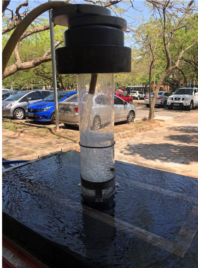
Figura 5.27 - Conjunto para ensaio de permeabilidade horizontal.
