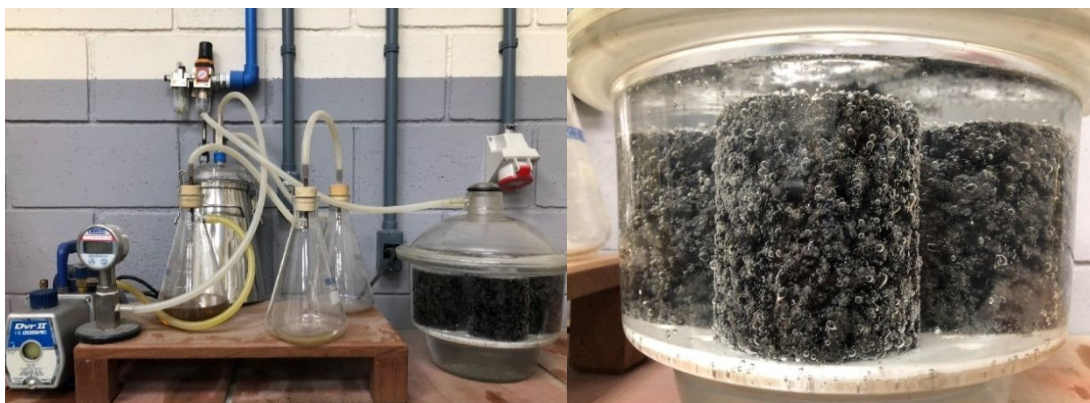
Figura 5.18 - Processo de saturação a vácuo dos corpos de prova.
