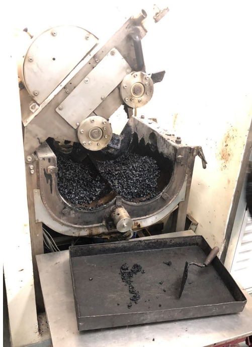
Figura 5.21 - Usinagem das misturas asfálticas em misturador do tipo pugmill .
