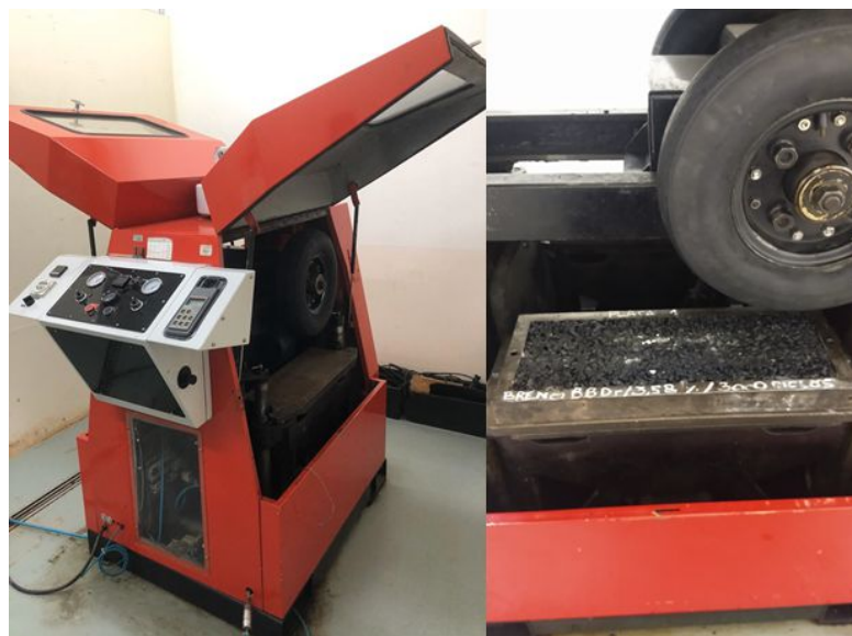
Figura 5.23 - Máquina de deformação permanente.
