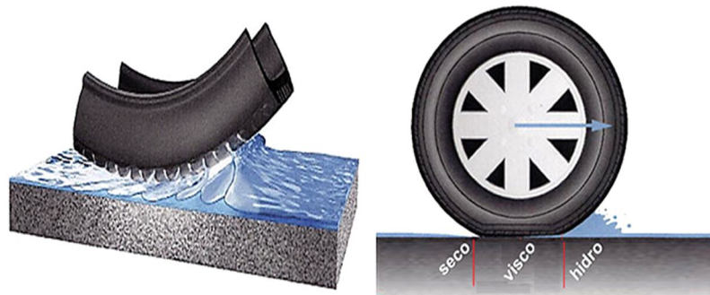
Figura 3.4 - Fenômenos de (a) hidroplanagem e viscoplanagem, (b) efeito spray e (c) espelhamento ou reflexão.
