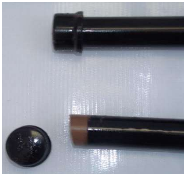
Figura 85 - Colocação dos tampões nos canos.
