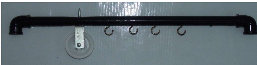
Figura 106 - Parte superior com roldã fixa e gancho de rosqueáveis de ancoragem.
