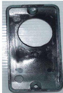
Figura 90 - Tampa do condutele com furo.
