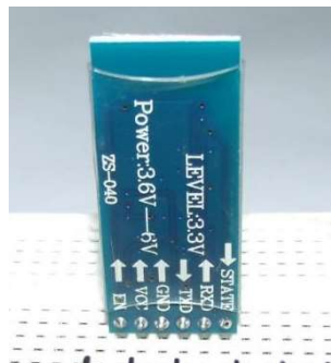
Figura 69 - Módulo bluetooth pinado na protoboard.
