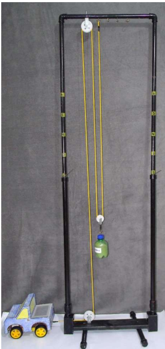
Figura 126 - Movendo peso com polias móveis.
