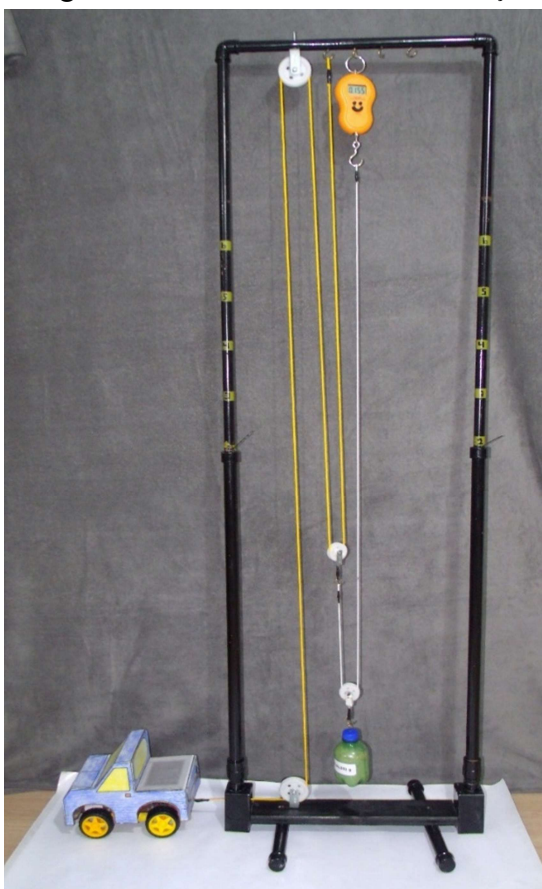
Figura 135 - Polia móvel com balança
