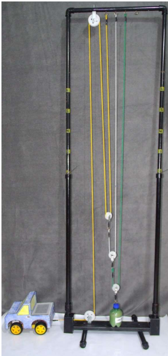
Figura 136 - Movendo peso com associação de polias.
