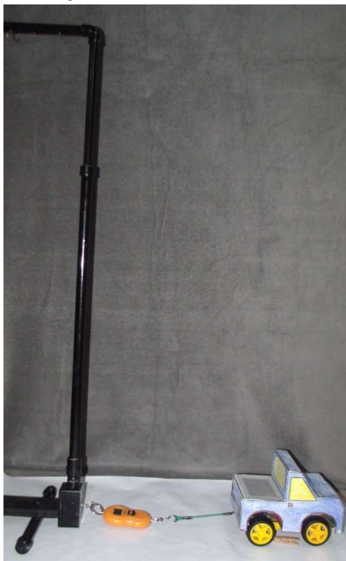
Figura 118 - Medindo a força de tração
