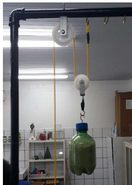
Figura 20 - Aparato com polia fixa e móvel.
