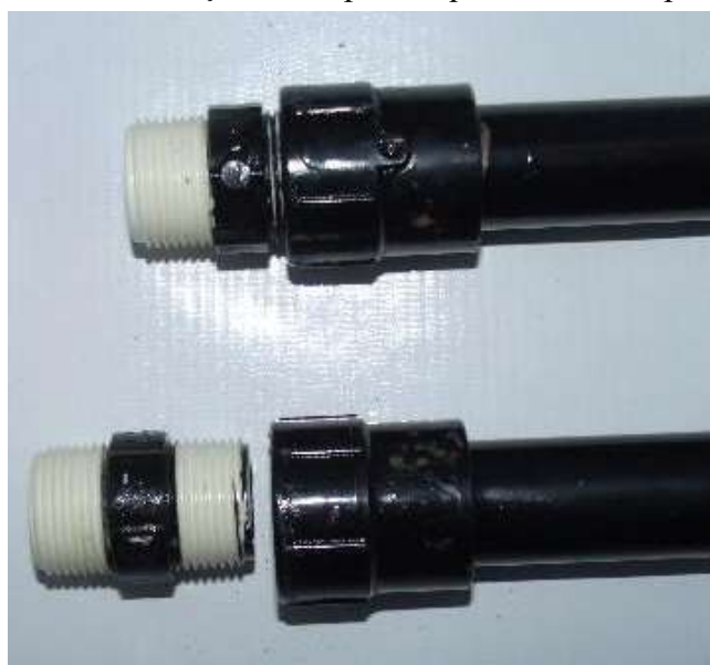
Figura 97 - Colocação das nípel rosqueável aos adaptadores.
