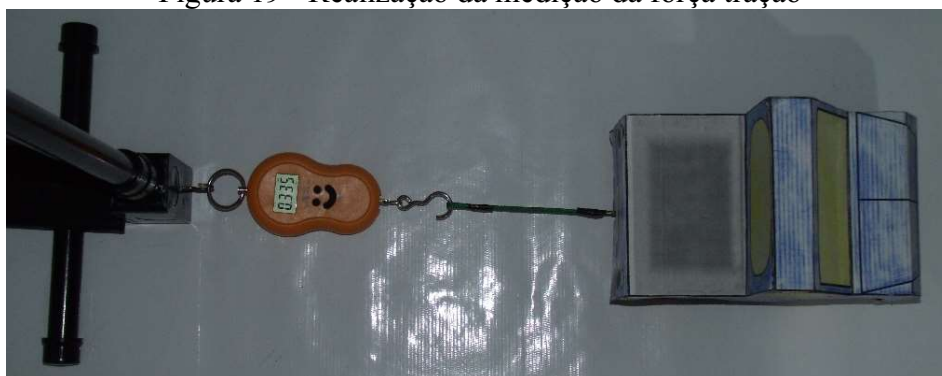
Figura 19 - Realização da medição da força tração
