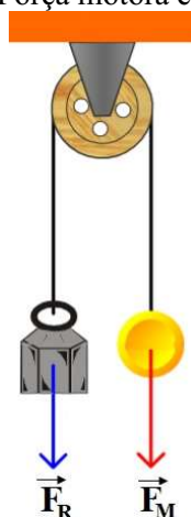
Figura 4 - Força motora e resistência.
