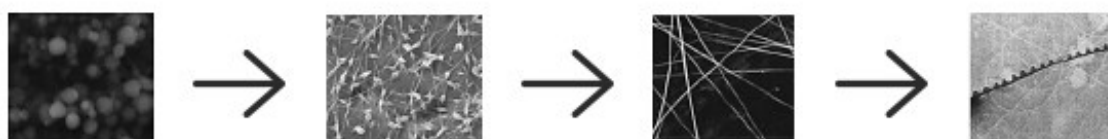
Figura 3 – Variação da concentração da solução polimérica na morfologia das fibras no processo de eletrofição.
