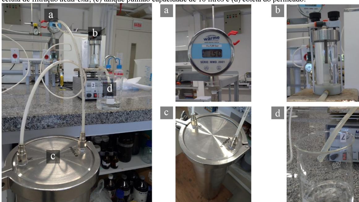
Figura 11 – Aparato experimental para permeância: (a) manômetro digital de pressão do sistema de ar-comprimado, (b) célula de filtração dead-end , (c) tanque pulmão capacidade de 10 litros e (d) coleta do permeado.
