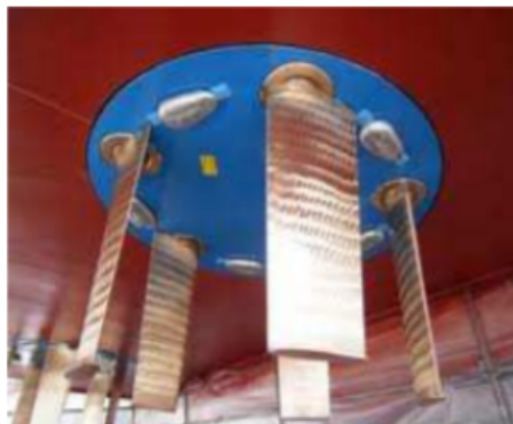
Figura 3 – Lâminas verticais móveis de um propulsor cicloidal.
