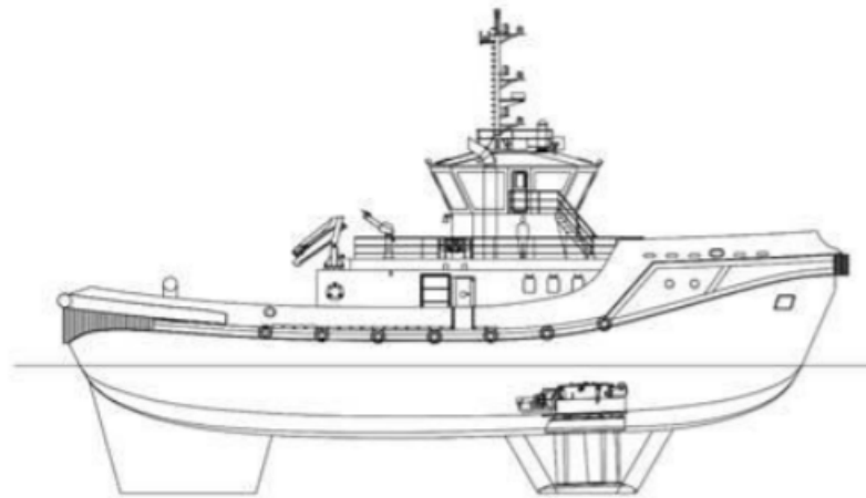
Figura 4 – Rebocador de Propulsão Cicloidal.
