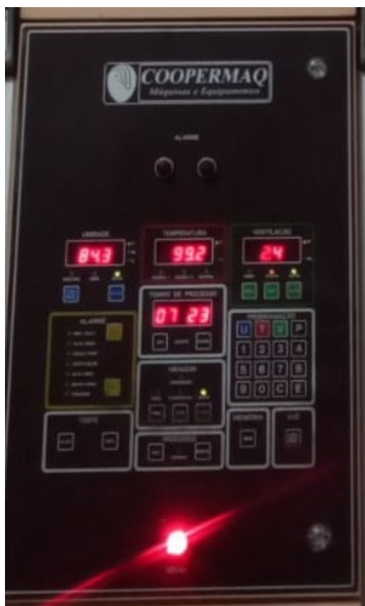
Figura 6 – Primeiro modelo de painel de controle de uma das câmaras de incubação da Avícola Catarinense.
