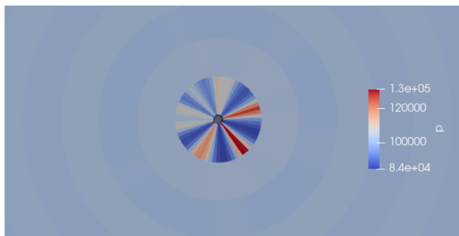
Figura 24 – Assimetria próximo à fonte para zona útil uniforme de 16 PPW ( t = 0,50 s).
