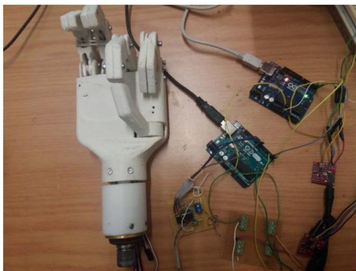
Figura 31. Configuração de teste de protótipo Touch Hand 3.
