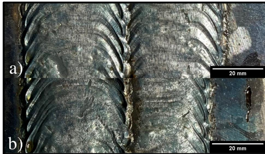
Figura 38 – Cordões de solda depositados adjacentes resultantes da variação da distância entre os centros dos cordões de a) 35 mm e b) 30 mm.
