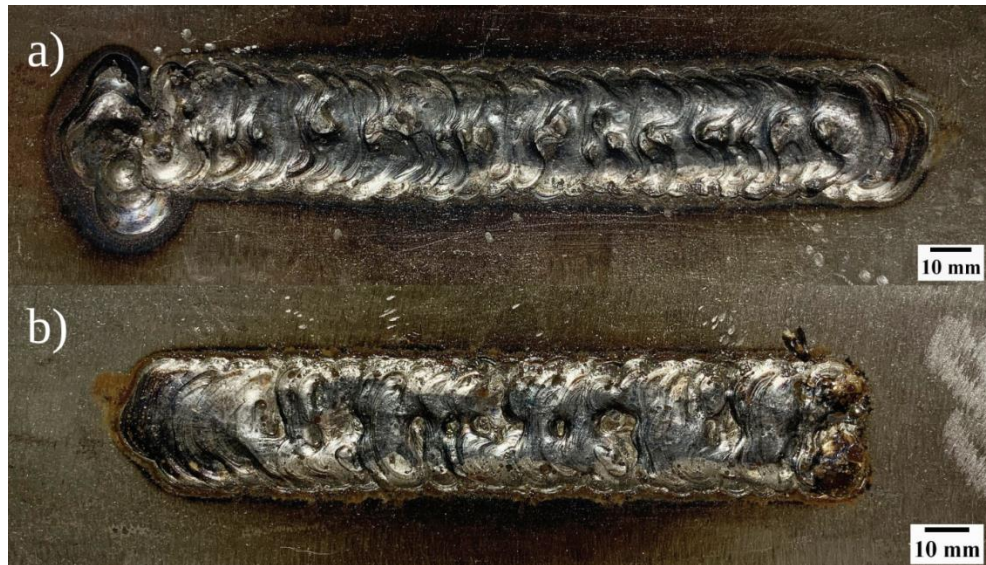
Figura 30 – Cordões de solda produzidos com amplitude de tecimento de 25 mm, Va de 1,5 m/min e ângulos de ataque de 90° (a) e 70°E (b).
