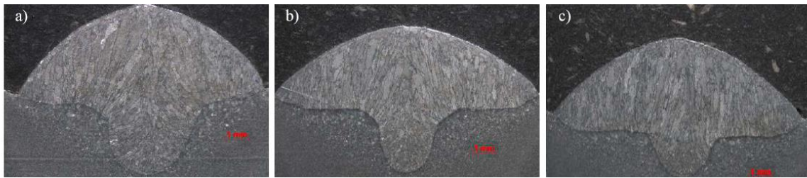
Figura 8 - Seções transversais das soldagens empurrando com ângulo de (a) 0°, (b) 15° e (c) 30°.
