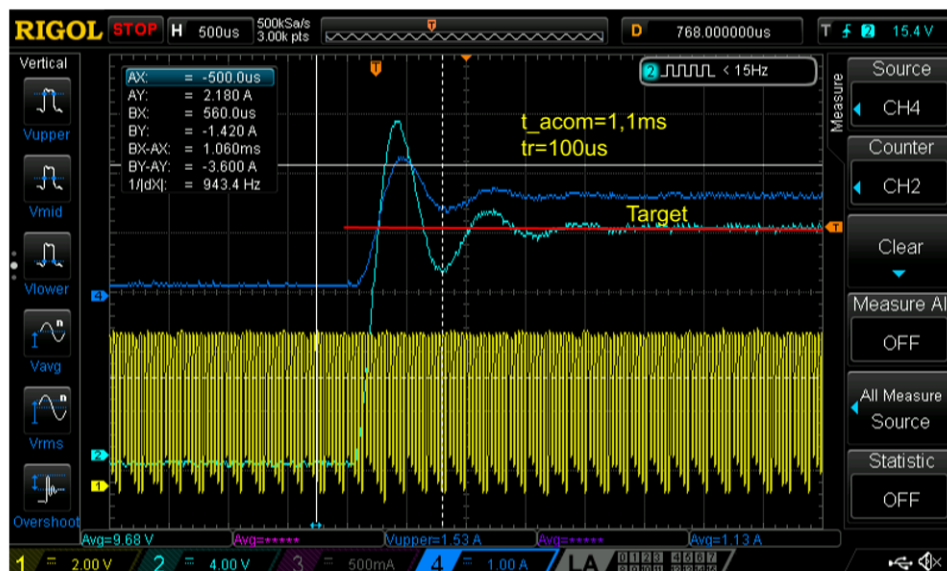
Figura 60 – Tensões e corrente de saída com carga RL do conversor Buck
