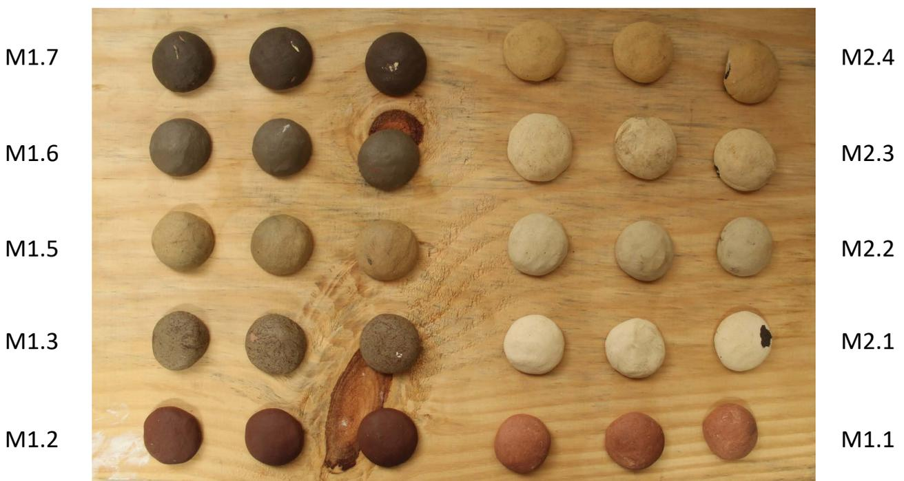
**Figura 59** - Amostras de argila feitas para ensaio de absorção e contração
