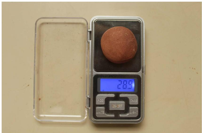
**Figura 62** - Amostras sendo pesadas com balança de precisão
