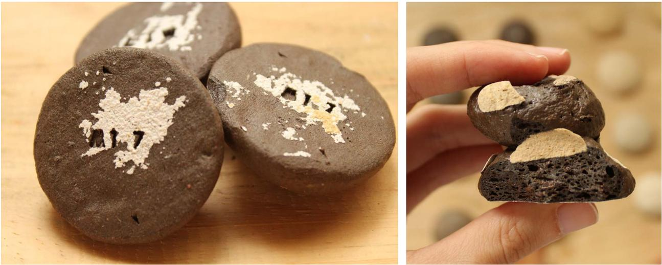
**Figura 60** - Massas M1.4 e M1.7 fervidas e derretidas devido ao baixo ponto de fusão
