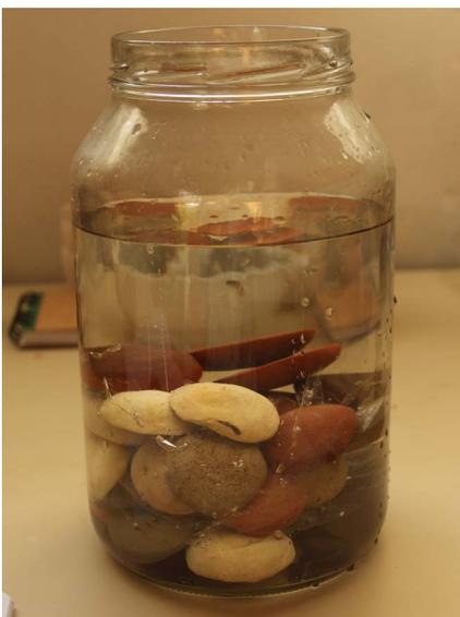
**Figura 61** - Amostras submersas em água por 24 horas
