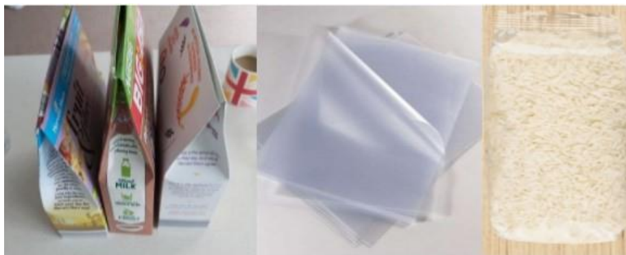
Figura 1: Caixas cartonadas para cereais, sacos de PEBD e arroz embalado em saco de PELBD.
